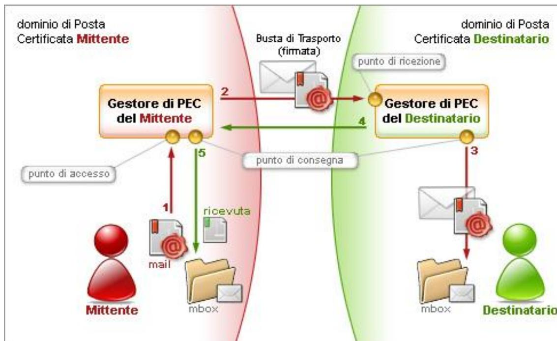
Figura 1 - Funzionamento di un sistema di PEC
